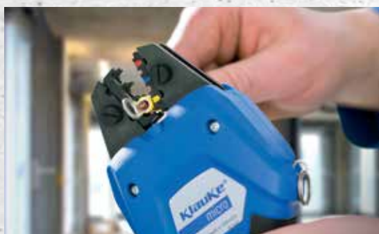
Mikro elektromechanické krimpovacie kliešte 0.5 - 50 mm 2 EK 50 ML
